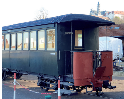
Anlässlich des WTU-Tages an frischer Luft: Der HMB 5 mit frisch grundiertem Perron und neuer Dachhaut.
